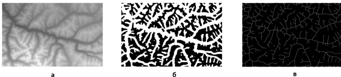
Рис. 2.5.2. Этапы обработки карты высот: а) исходное изображение, б) бинаризация (а) при помощи адаптивного порогового фильтра, в) скелетизованное изображение по (б).
